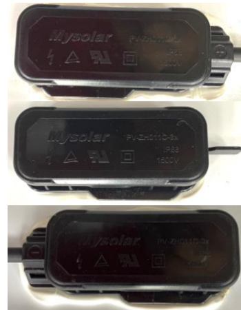
Fig. 16: Detail view of junction box of module type MS410M-HA Fig. 16: Vista detalhada da caixa de junção do tipo de módulo MS410M-HA
