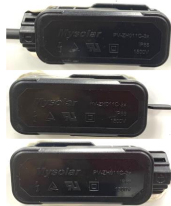
Fig. 20: Detail view of junction box of module type MS510M-HA Fig. 20: Vista detalhada da caixa de junção do tipo de módulo MS510M-HA
